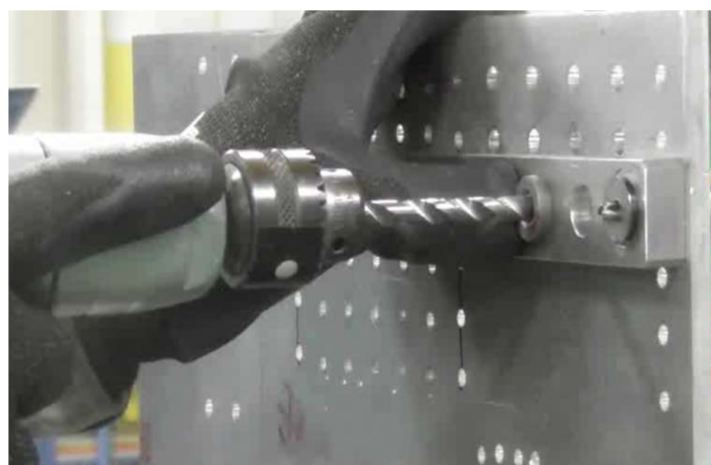
実機によるドリル穿孔実験
