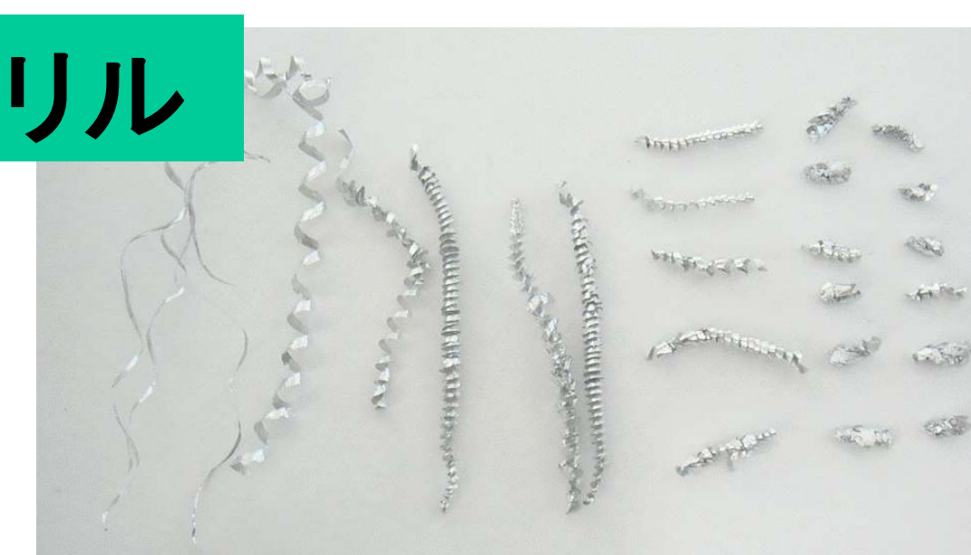
ヘリカル巻切屑、円筒型切屑、せん断型切屑
