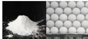
SiO2を採用 (宇部エクシモ(株)製、ハイプレシカ、粒径1μm)
